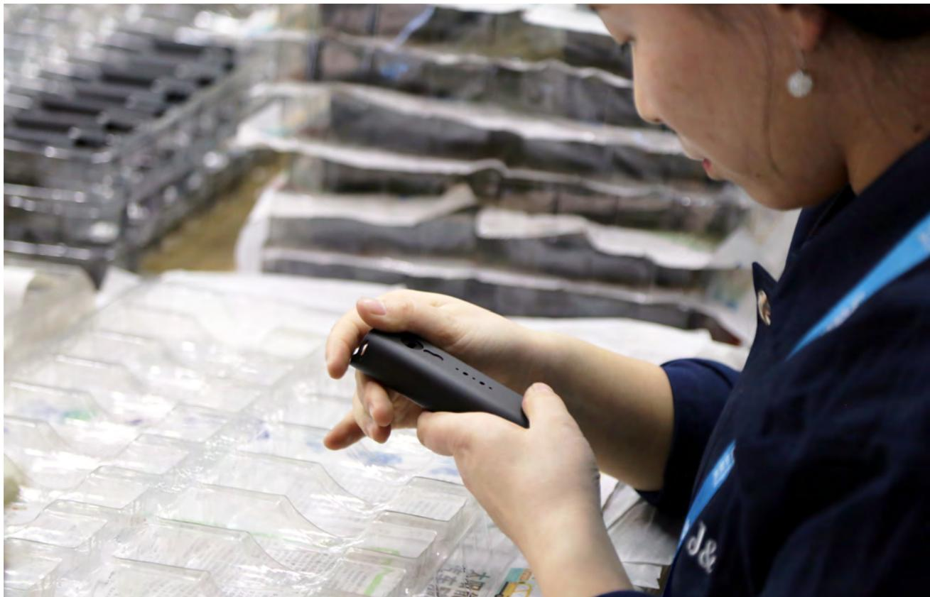
Gaciron のライト製造は自社工場でアルミニウム合金の素材から削り出し・加工を行うところから始まり、各製造工程で実際に手にとって厳しい品質管理を行っています。また様々な環境でライトをお使いいただくことを想定し、温湿度試験のほか、防水機能・落下試験・ボタン耐久試験・USBプラグ耐久試験などを実施しています。
