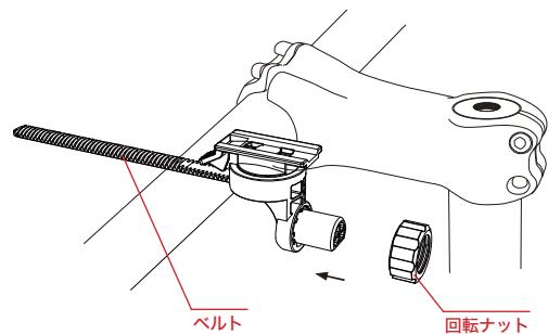
プラケットのベルト部分はハンドル部分にしっかりと巻き、ぐらつきが無いように締めた上で、回転ナットでハンドルバーに固定してください。
