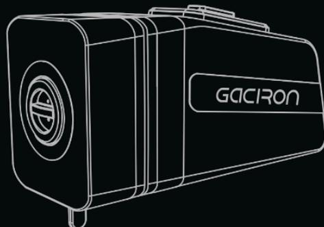
テールライトをライトスロットに合わせて挿入します。磁力によりテールライトが自動的に正しい位置に固定され、取り付けが完了します。
