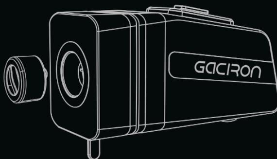
テールライトのつまみ部分を指でつまみ、時計回りに90度回してください。磁力の反発によってライトが押し出され、簡単に取り外すことができます。
